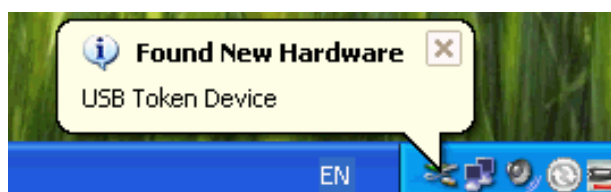
Рис. 15. Сообщение что USB-токен «iBank 2 Key» исполнение «М» корректно распознан операционной системой
